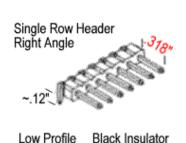
HWS15613 NUMBER OF PINS: 40 **1X40 SINGLE ROW BREAKAWAY** RIGHT ANGLE LOW PROFILE HEADER .1"(2.54mm) CENTERLINE .025" SQUARE POSTS .318" MATING SIDE POST LENGTH **GOLD FLASH PLATING**
